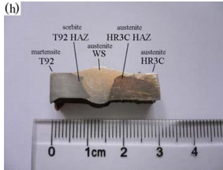
(h) 焊接接头示意图
