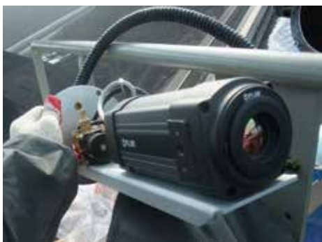
FLIR A310红外热像仪安装在传送带上方的防水外壳内。
