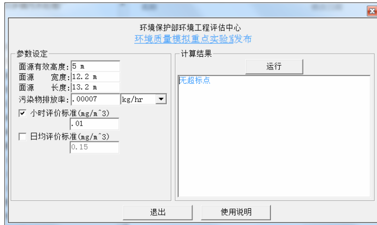
图 14 IBR 生物反应池大气环境保护距离计算结果截图 (H 2 S)
