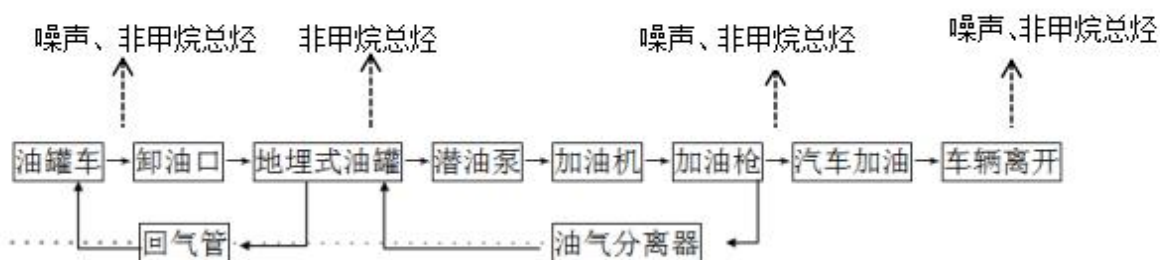
图 5-2 运营期工艺流程及产污节点示意图
