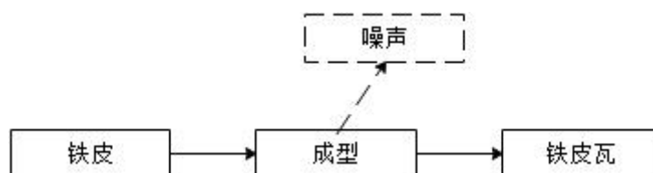
图 5-3 铁皮瓦工艺流程图及产污节点图
