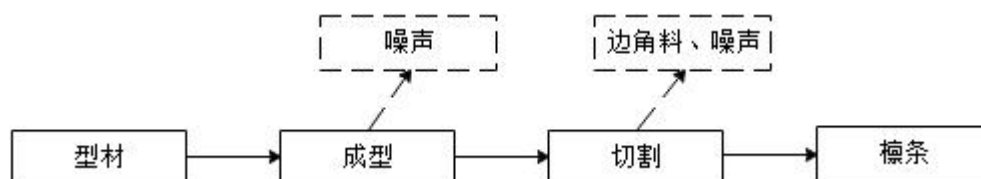
图 5-2 檩条工艺流程图及产污节点图
