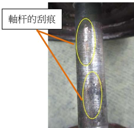
圖 10 柱塞的軸杆
