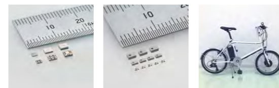
移动通信用FBAR/SAW器件
