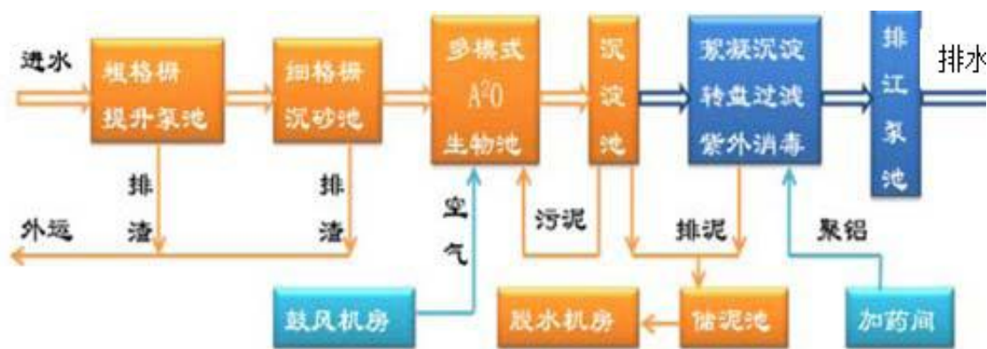
图 7-5 老坝港滨海新区污水处理厂工艺流程图
