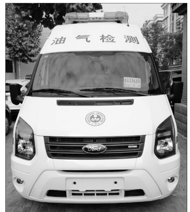
山东省淄博市近日引进移动式专业油气排放检测车,主要用于检查加油站储油罐卸油口、油气回收接口和管路是否有跑冒滴漏现象,油气回收是否充分等。今后,油气回收检测将会成为淄博市的一种常规检测指标。 董若义 毕霄燕摄
