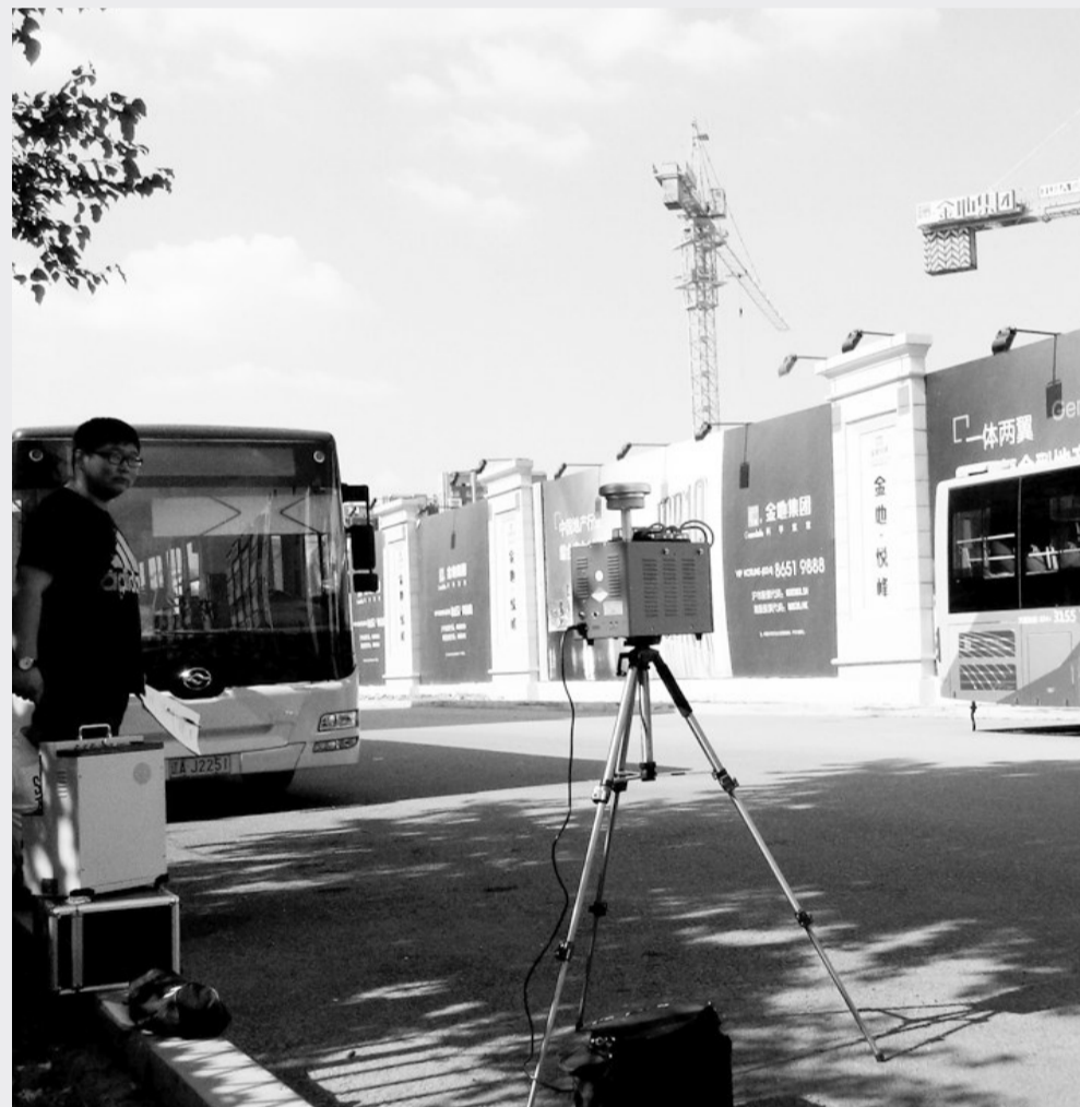
工作人员在监测施工及堆料场地扬尘。
