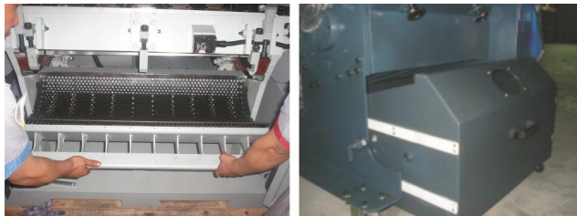
图 3-9: 筛网、网架及集料盒安装
