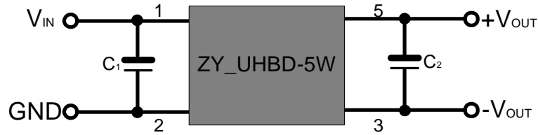
图 5.1 ZY_UHBD-5W 接口电路
