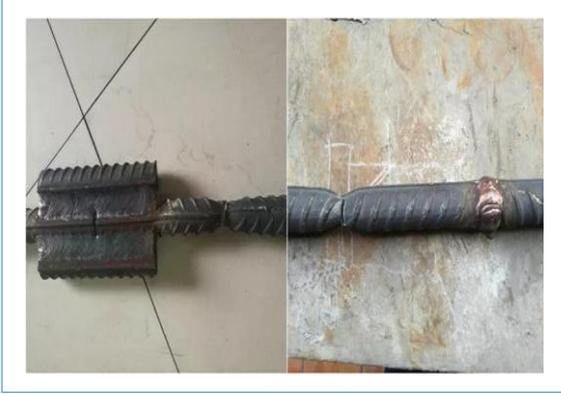
2018 年 1 月研发出双金属复合钢筋多层复合焊接工艺，实现了双金属复合钢筋的高质高效焊接。
