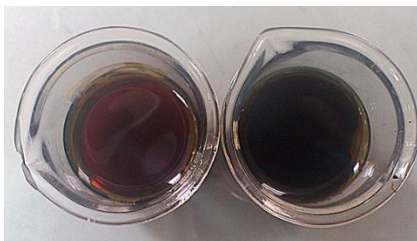
图 11 EA-124 清洗前后清洗液对比图
