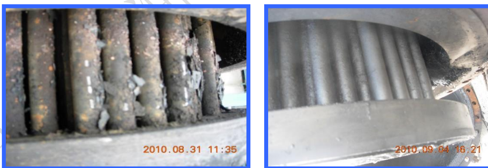
图 7 常减压装置 412/1B 清洗前后管束对比
