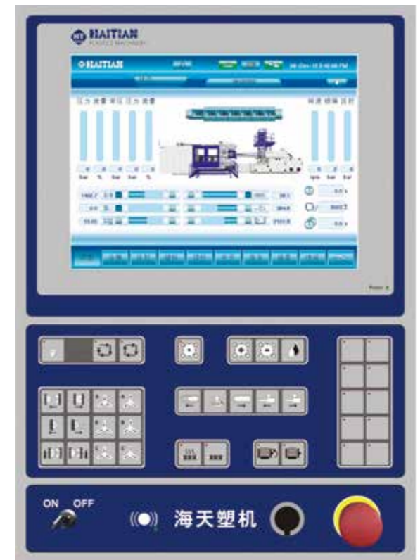
特殊设计的二板机专用控制器 控制面板采用LCD彩色大屏幕，实时监测生产进程，并显示各种故障诊断
