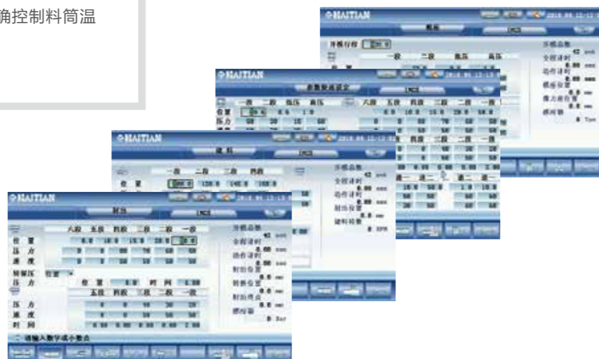
特殊设计的二板机专用控制器 控制面板采用LCD彩色大屏幕，实时监测生产进程，并显示各种故障诊断
