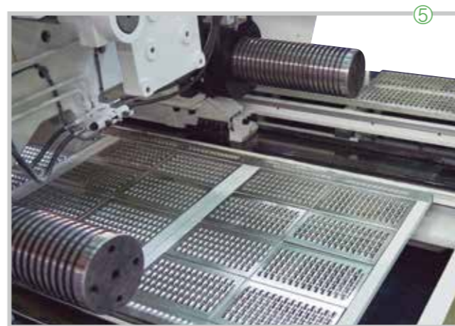
图片③ 倒置式顶出装置，顶出行程由电脑控制，可任意设定。
