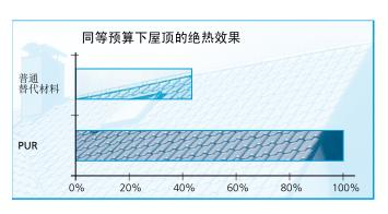
相比之下,HFC发泡的PUR 泡沫在遏制气候变暖方面 的表现如何? 除了高性能的解决方案(比如PUR喷涂泡沫)之外,可能会考虑其他不同的解决方案。然而,另一项独立的研究表明:即使考虑发泡剂排放问题,由于在给定预算内实施保温改造的屋顶数量较大,SOLKANE® 365mfc发泡的PUR喷涂泡沫解决方案也可以比普通的替代方案减少更多的CO<sub>2</sub>排放。
