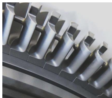
图 6 透平叶片组件(喷丸后 R_a < 0.5 \mu\text{m} )
