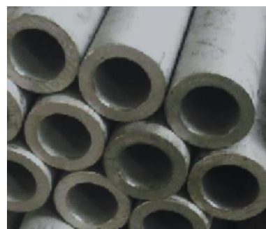
图 3 高压锅炉管内壁喷丸(管长>20 m)
