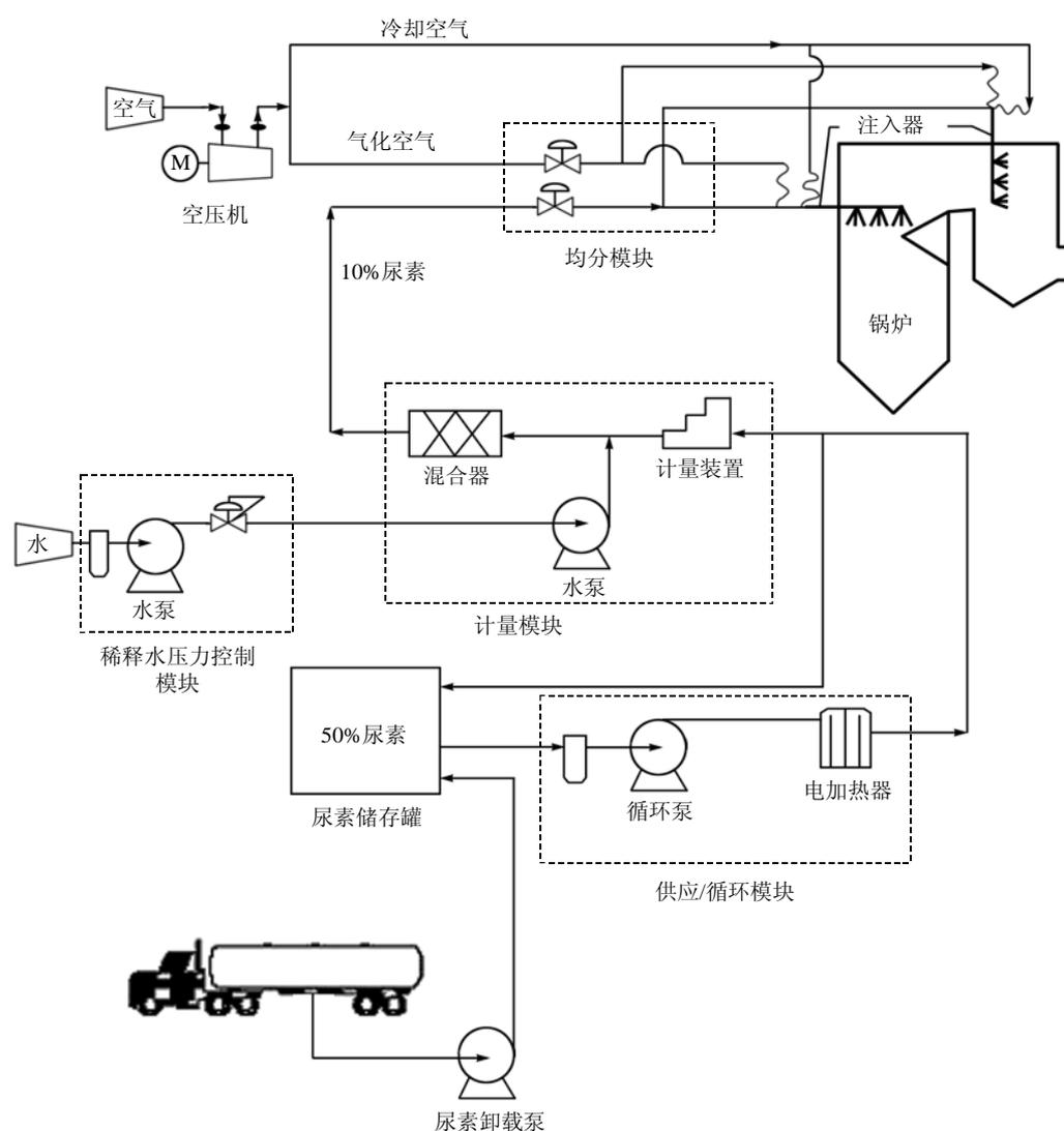
图 B.1 尿素 SNCR 系统工艺
