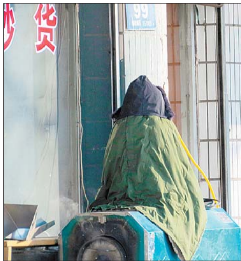
▲@细数青山望蓬莱:街头一瞥。爆米花机用上了半自动，昔日落后的设备焕发了青春。机上安装了一个保密装置，带动两个齿轮驱动爆米花机旋转。炉子底部还有鼓风机吹气。电源由电瓶供给。
