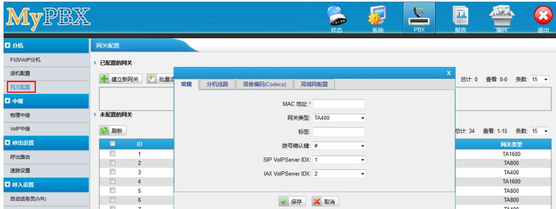
MyPBX 支持两种网关自动配置模式：PnP 模式和 DHCP 模式，您可以在 NeoGate TA 网关的自动配置页面选择通过哪种模式进行自动配置。
