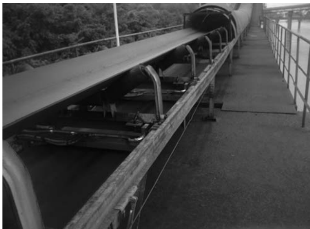
图3 更新后的西门子双托辊皮带秤
