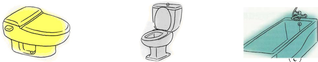
圖 2 【常見馬桶及浴缸形式：(a) 單體馬桶 (b) 水箱沖水馬桶 (c) 常見浴缸形式】
