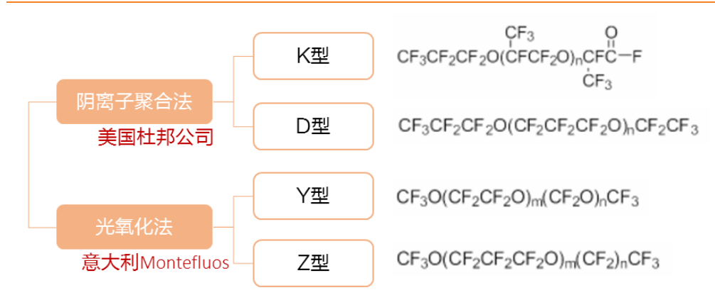
图 30：PFPE 的制备及结构
