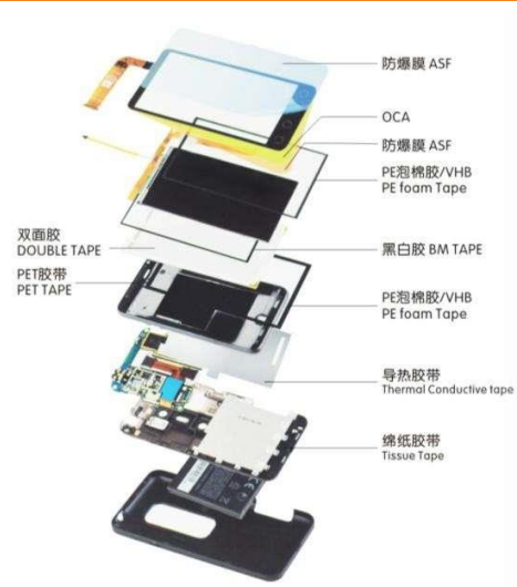
图 17：OCA 光学胶在触摸屏中的应用
