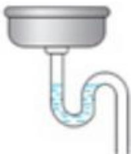
回水管的水封阻隔臭气
