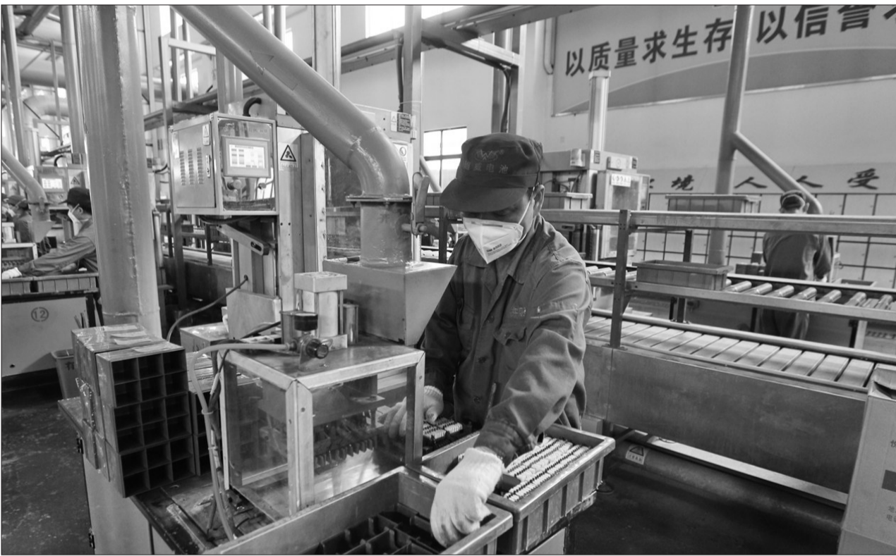
浙江超成集团自主研发了“原子经济法铝回收工艺”,这项技术通过原子经济反应,将废旧电池中的铝膏转化成可直接利用的铝粉,处理过程中无烟尘、废气、废水排放,回收利用率高达99%以上。图为工人在安装铝烟粉尘回收系统电池生产线。 本报记者邓佳摄
