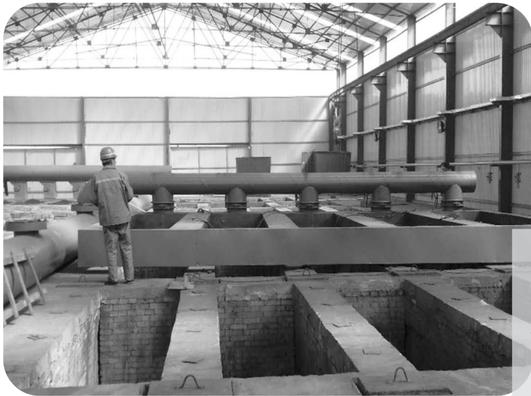
成安县四海实业有限公司碳素焙烧坑周边安装侧吸装置后,除尘效果明显。资料图片
