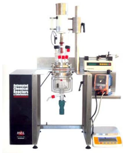
每个 Auto-lab 系统都按用户的特定用途进行配置，选择合适的反应器、加热/冷却器、进料系统，还有各种传感器，以严格适合要解决的化学问题。全自动反应器需要提供化学工艺放大和工厂设计必须的数据，该仪器是车间生产中反应釜的真实模型的模拟，化学过程或单个步骤在接近实际的条件下以升级规模进行，所有的过程变量都被测量和控制，全部实验数据实时自动采集，在线显示，还可离线分析和存档，如：温度、压力、加料操作、混合等，从升级规模获得的结果可放大至工厂生产条件，或反过来，工厂中的生产过程能缩小到升级规模，从而容易地得以研究和最优化。该仪器是保证放大工业生产的安全和获得高效的工业生产数据。
