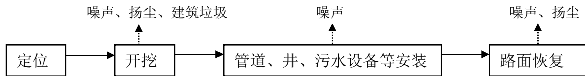
图 5-1 项目农村污水处理施工工艺流程图
