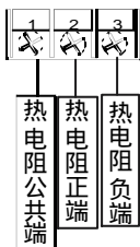
三线制 热电阻信号
