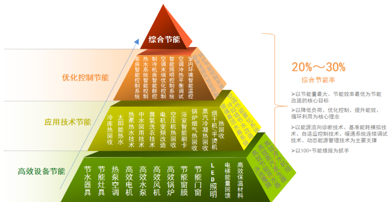
图 5-11 公共建筑综合节能改造技术体系
