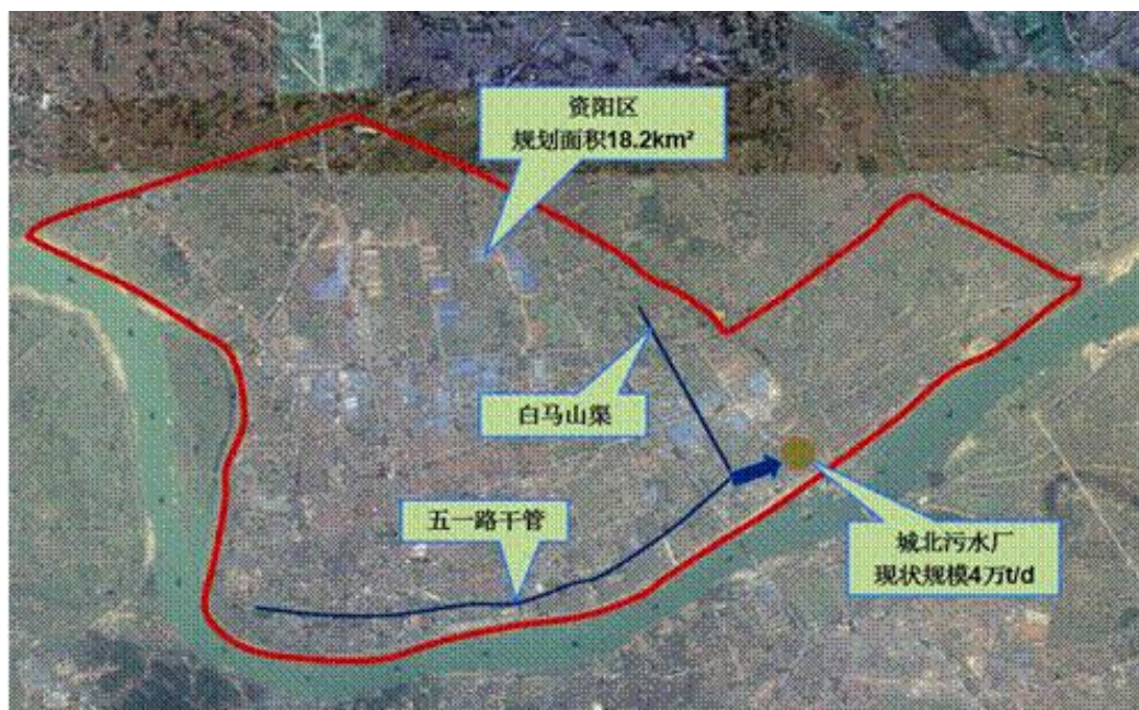
图 7-1 城北污水处理厂管网现状及服务范围示意图
