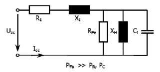
空载损耗包括铁芯损耗、绕组损耗和绝缘损耗。通常绝缘 损耗和绕组损耗的数量级远小于铁芯损失,可忽略不计。 空载损耗测量可检测出样本铁芯在短路或饱和状态下的 缺陷。
