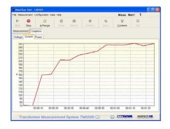
TMS 软件包括测量值历史记录功能,用以获知所有存档数据。可单独标注测量值,以基于存档数据编辑用户自定义报告。TMS 580 也可接收来自 2291、2292 和 2285 型电阻计的测量数据。
