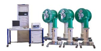
损耗测量是电力变压器质量验证程序中必不可少的一步。由于变压器在负载及无负载模式下的功率损失通常由用户 买单,尽可能精确地测量功率损失在经济上极为重要。TMS 580 专为变压器功率损耗的高精度测量研发。
