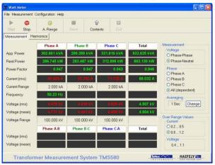
显示常规测量值的同时, TMS 580 软件也在一旁显示测得的谐波。这对无负载测量时确定电压和电流失真尤为有用。
