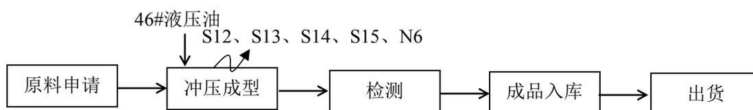
图5-4 冲压件生产工艺流程图
