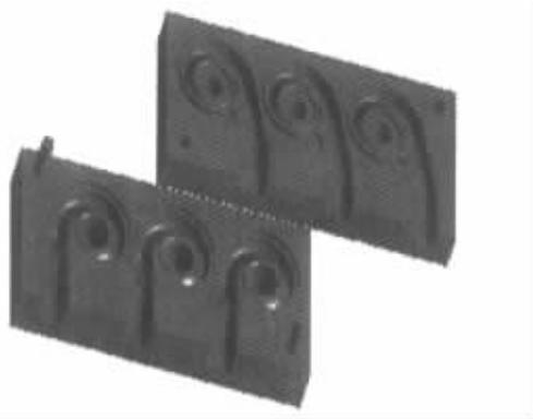
图3 涡轮增压器的流道芯盒模具三维实体造型
