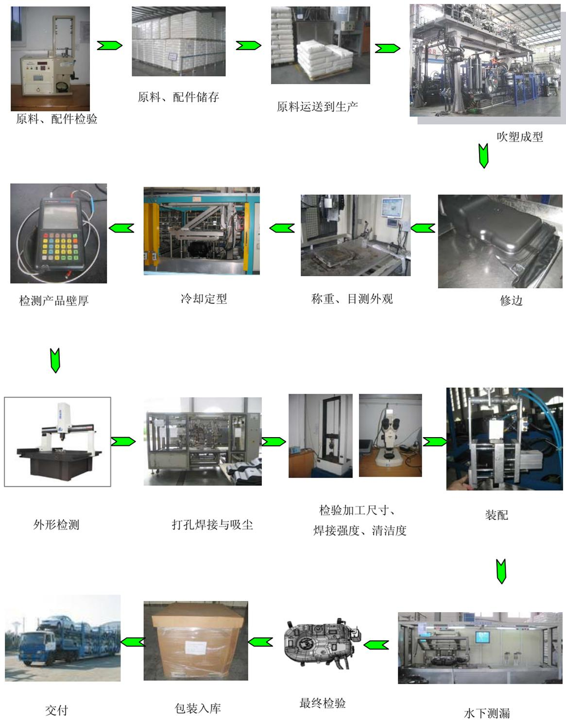
公司生产工艺流程由生产部负责实施完成，生产部下设吹塑车间、注塑车间、修边车间、物流科、模具车间和机修车间。吹塑车间完成六层共挤汽车塑料燃油箱总成生产的全部过程，注塑车间为塑料燃油箱总成提供塑料焊接件，模具车间负责制造吹塑模具，机修车间提供维修保养等生产保障服务。公司生产环节的主要设备、主要产品、生产各环节的人工、设备配置情况如下：
