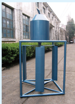
1.5kW 的潮流发电样机
