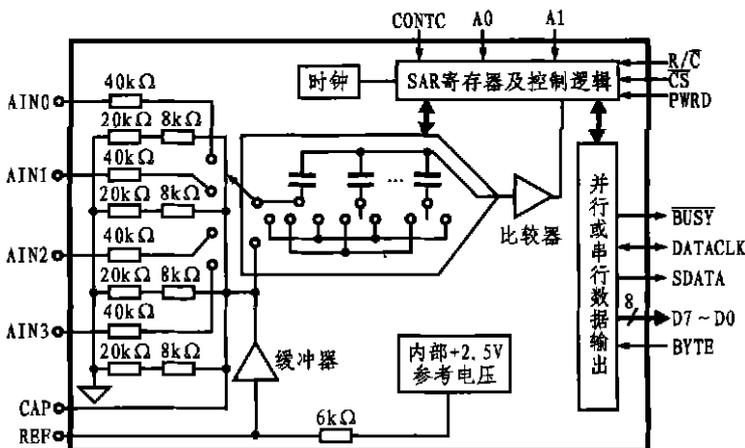
图 1 ADS7824 的内部结构框图
