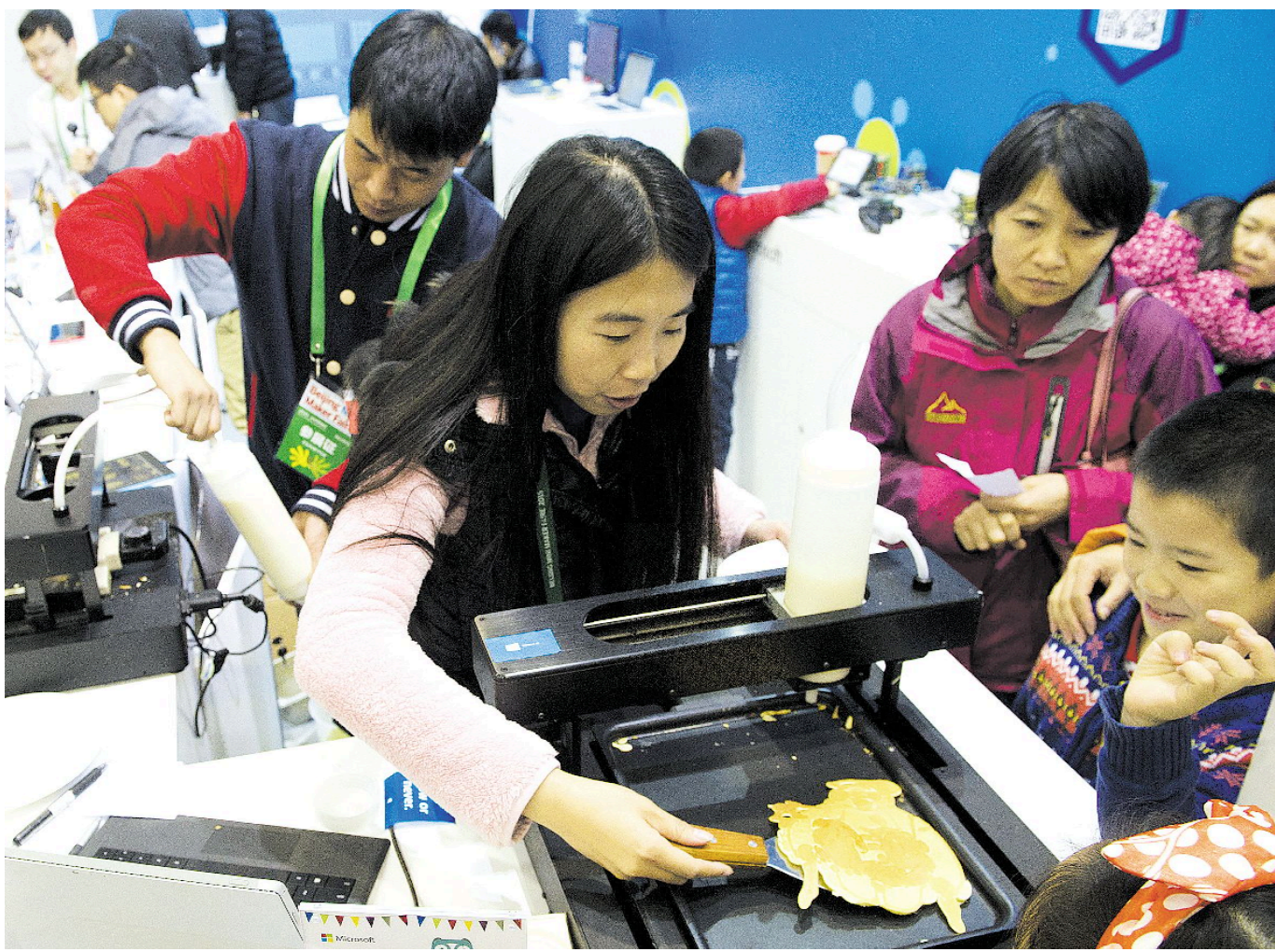
11 月 8 日,一名小朋友在等待品尝 3D 煎饼打印机制作的煎饼。这款 3D 煎饼打印机颇受小朋友喜爱,操作者只须在平板电脑上画出图形,相连的机器就可以“打印”出同样形状的煎饼。
