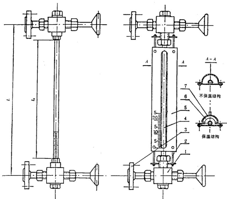
1- 阀门; 2- 拉紧螺栓; 3- 法兰; 4- 玻璃管; 5- 标尺; 6- 保温管; 7- 保护套。
