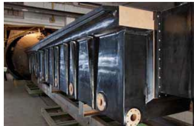
上面图片：使用固体KERA为纺丝纤维工业制造的大桶。
