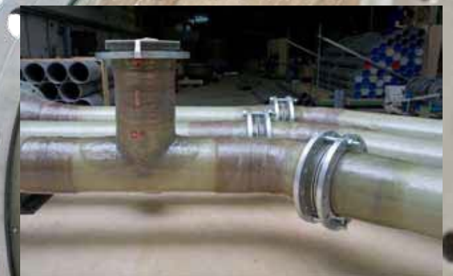
上图: 用于发电站的由PP和玻璃纤维增强塑料制成的环形管。
