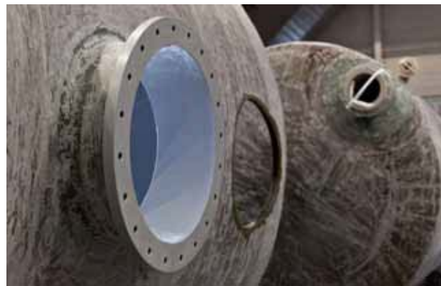
上面图片：在制造过程中由PVDF和玻璃纤维增强塑料制成的罐。
