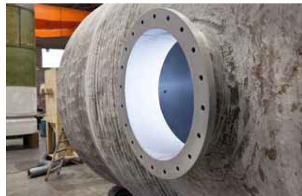
Above picture: 由PTFE和玻璃纤维增强塑料制成的处理箱。
