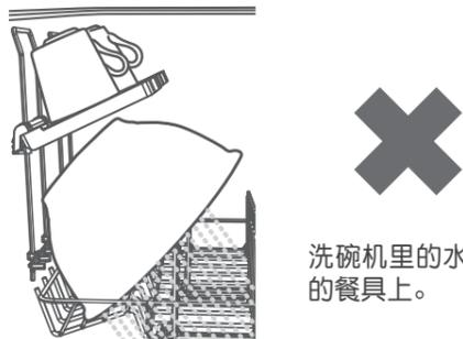
洗碗机里的水喷不到可调节杯架上的餐具上。
