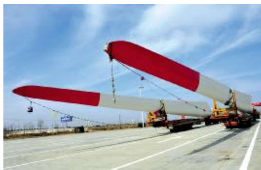
基于竹材生产的风电桨叶。
