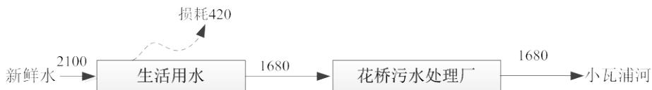
图 5-2 项目水平衡图 (单位: t/a)
