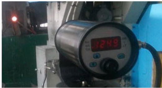
铜材测温现场
