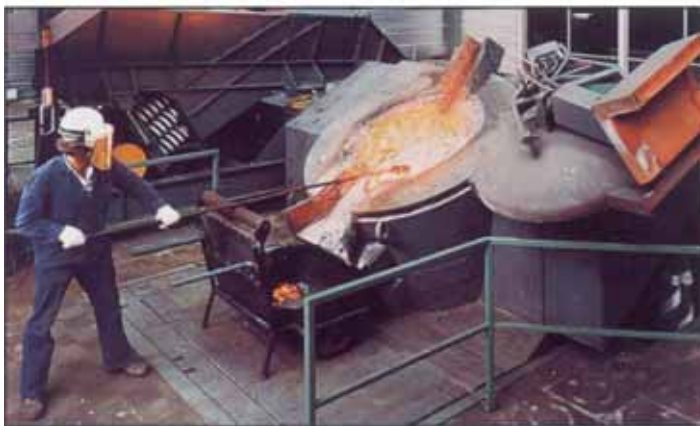
铸造工人在配有后倾机构的感应电炉上清除炉渣。后倾机构便于清渣
