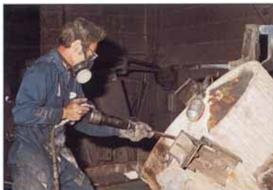
铸造工戴着防尘面罩（自保护呼吸）在除去感应电炉内的耐火炉衬
