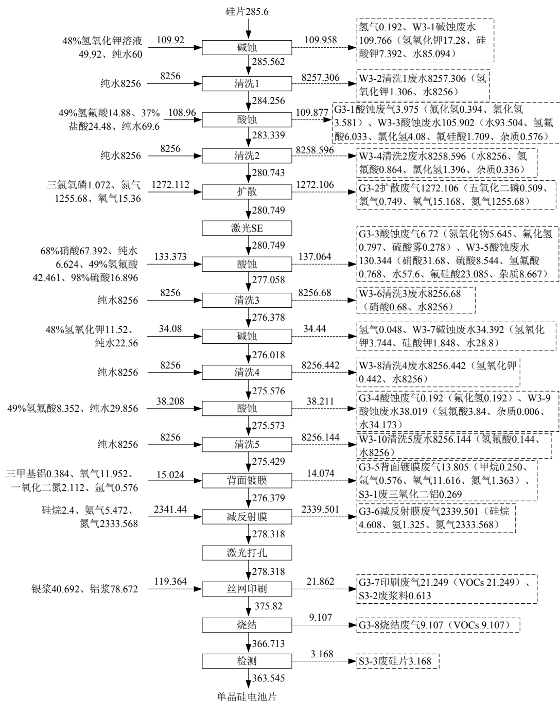
图 3.6-1 单晶硅太阳能电池生产物料平衡图 (单位: t/a)
