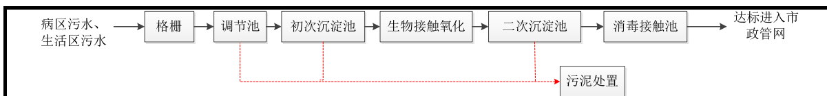
图 4 现有污水处理站处理工艺流程图
