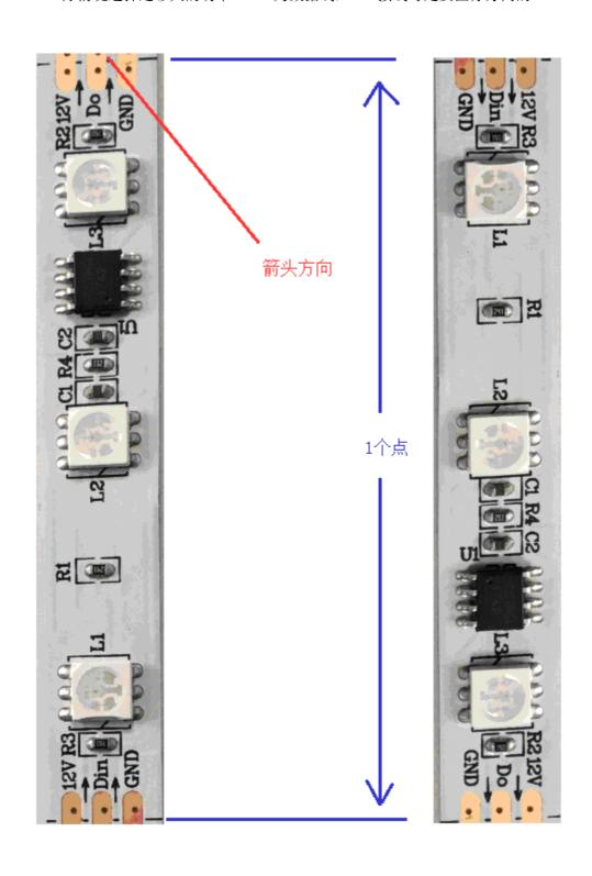
二、F102 支持一列的点数为 20 至 50 点,最多二拾列(20 列,建议 17 列以上较有音乐频谱的效果)。现以 3 点为例说明安装接线图(实际安装时至少要求一列 20 个点)。规定第一列为低音部分(音频频谱),<mark>规定第一列的方向为由地向天</mark>。每列点数必须相同。下图中红、蓝电源线建议用 1.5 平方 mm 以上的铜电线。 为了保证电流请每 5 米并接 12V 电源。
