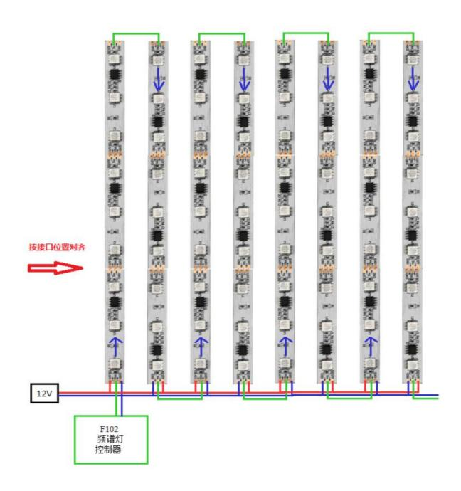
12V 红蓝电源线用 2.5 平方 mm 的铜电源线。
