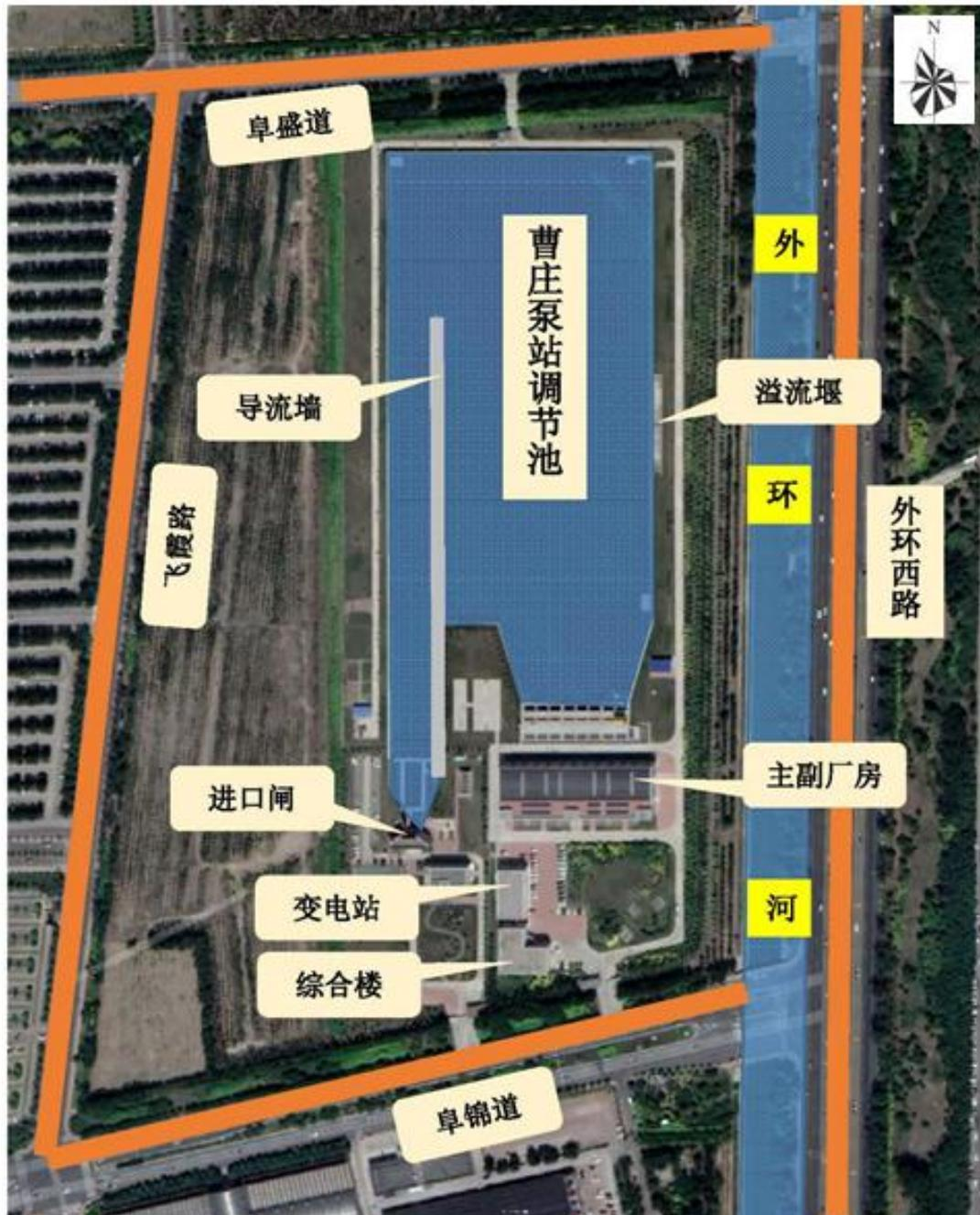
图 2 曹庄泵站调节池清淤工程总平面布置图
