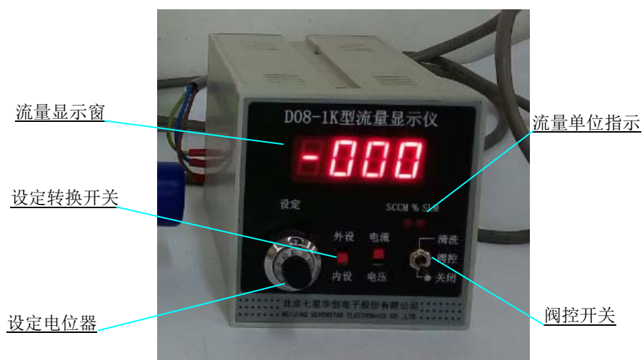
图 10. 流量显示仪操作面板
