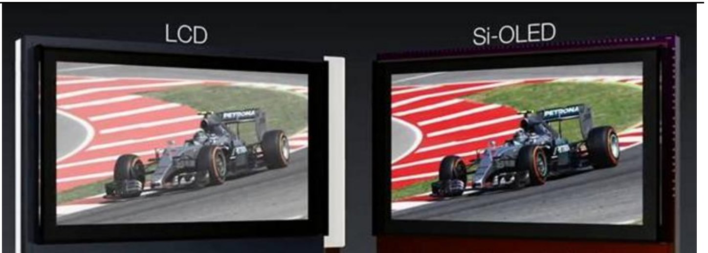
图表 1：硅基 OLED 显示技术相对 LCD 显示技术具备更高对照度、亮度和更鲜艳的颜色
